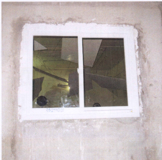
Foto 1: Janela instalada vista da câmara de emissão sonora.
